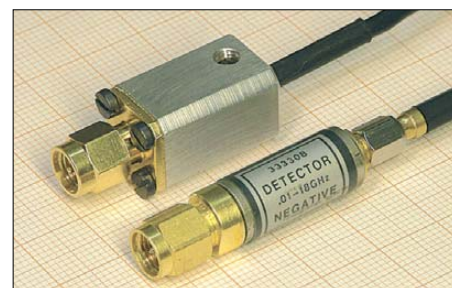
Bild 2: Eigenbau-Messkopf SMA (oben) und kommerziell hergestellter Messkopf hp33330B
