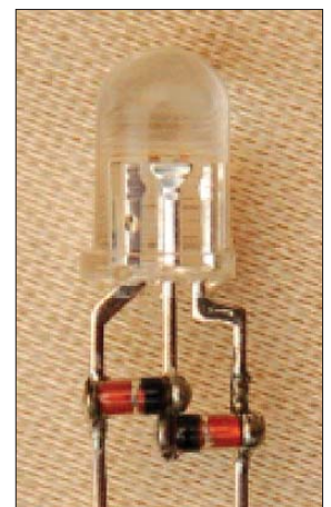
Bild 4: Der Muster-aufbau zeigt die Möglichkeit aus Bild 3, wie man eine „Trio-LED“ zur „Duo-LED“ umbaut.
