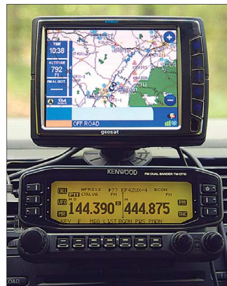
Bild 2: geosat 5 und TM-D710E bilden im Verein ein APRS-taugliches Navigationssystem.
