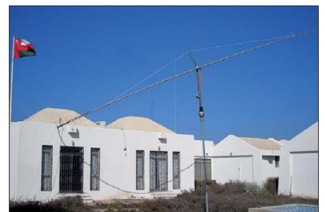
Mit der 38-Element-Yagi glückte A43DLH unter anderem auch ein QSO mit Jan, DL9KR, der mit Oman sein 101. DXCC-Gebiet auf 70 cm abhaken konnte. Foto: DL8YHR
