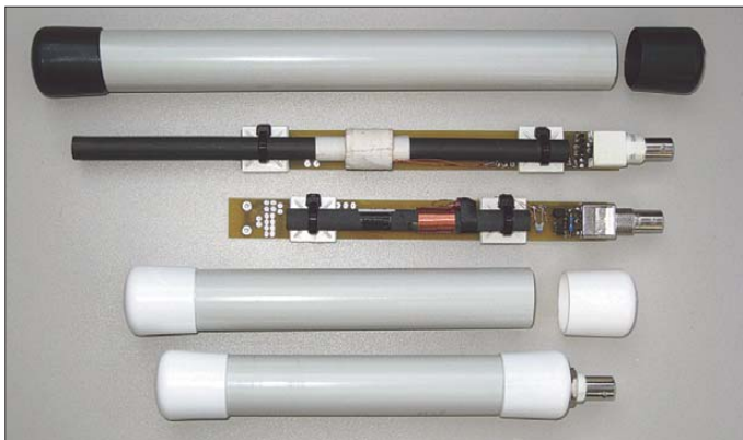
Bild 12: Ansicht der beschriebenen Ferritantennenmodule und der dazugehörigen Gehäuse; oben passive Version, unten aktive Version
