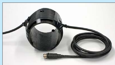
Bild 17: Einfache Mantelwellensperre durch geordnetes Aufwickeln des Koaxialkabels (hier Aircell 7) zur Spule; bei 10 Wdg. bringt ein PVC-Rohr Stabilität. Foto: Red. FA
