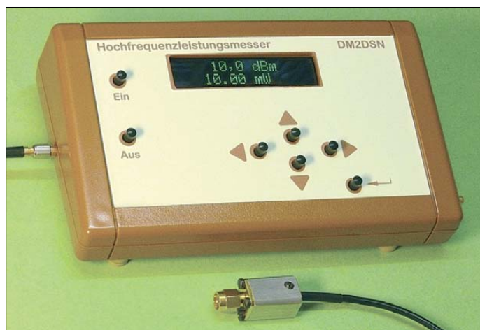
Bild 1: Leistungsmesser mit Messkopf SMA 100 kHz bis 3,3 GHz
