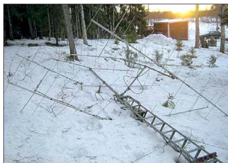
Zu Silvester 2008 zerstörte ein Sturm die 4er-Gruppe von SM2CEW (KP15CR). Aus den Resten konnte Peter am 1. und 2. 1. 09 noch zwei Yagis zusammenbauen, und so war SM2CEW bei den Quatrantiden dann doch noch QRV. Foto: SM2CEW
