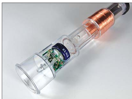
Bild 70: Inneres einer induktiv betriebenen Taschenlampe mit Doppelschichtkondensator als Energiespeicher
