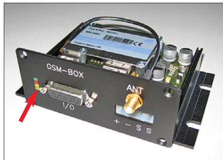
Bild 4: Neben der PC-Schnittstelle befinden sich vier LEDs, die Auskunft über den Betriebszustand der GSM-Box geben. Foto: DL5IN
