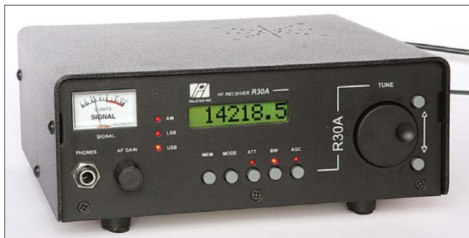
Beschränkung auf das Wesentliche: Der konventionell aufgebaute Doppelsuper empfängt von 100 kHz bis 30 MHz in SSB und AM.
