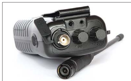
Oben liegen Buchsen zum Anschluss der Antenne sowie eines Lautsprechermikrofons. Auf der Rückseite ist der mitgelieferte Gürtelclip angeschraubt.
